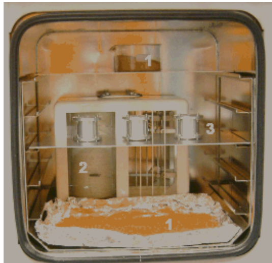
Abbildung 1: Versuchsaufbau im Luftthermostaten (1: Orangelgel, 2: Hydrograph, 3: Probengefäße)
